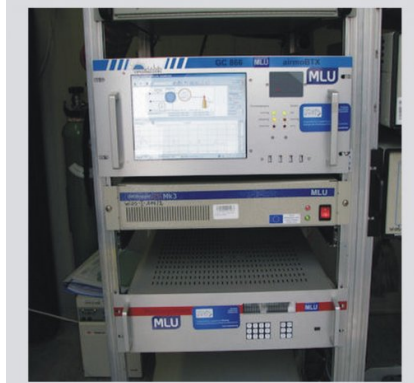
Analizator BTX z detektorem FID Airmo BTX 1000 model 866 z wytornicą wodoru Hydroxychrom i wbudowanym generatorem powietrza zerowego zakupiony w ramach projektu współfinansowanego z NMF
