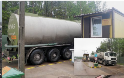
Cysterna wywożąca odciek do zewnętrznej oczyszczalni ścieków
