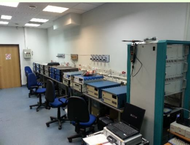
interkalibracje analizatorów gazowych w KLRiW
